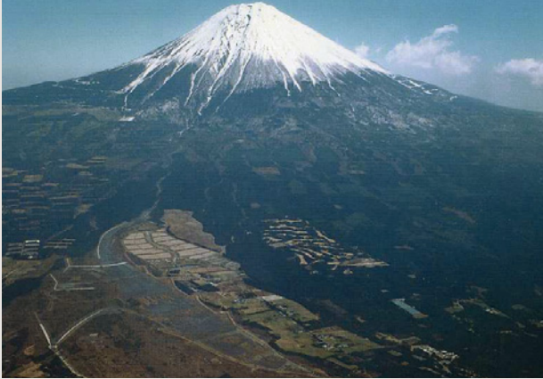
富士山の大沢崩れからの土砂を受け止める遊砂地が整備されている。
